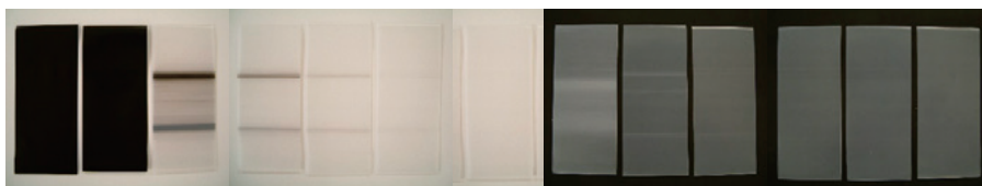
パワフルパージF-2 (使用量1.2kg) ⇒ PEナチュラル樹脂 (使用量1.2kg)
