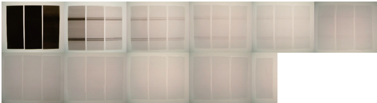
パワフルパージF-2 (使用量1.2kg) ⇒ PEナチュラル樹脂 (使用量1.2kg)
